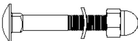
Šroub M10x56 (35) 4ks Oblouková podložka M10 (36) 4ks Koncová matice M10 (34) 4ks
