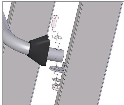
8. K masážnímu rámu připevněte dva podstavce pomocí šroubů M8 \* 55.
