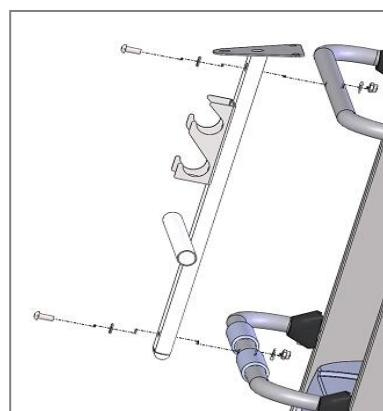
9. Odstraňte tři šrouby M8 \* 15 z masážního přístroje a následně s nimi připevněte masážní přístroj k masážnímu rámu.
