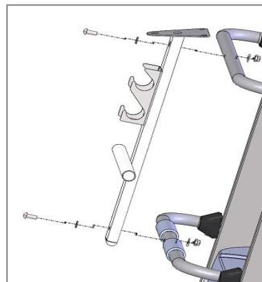
9. Wyciągnąć trzy śruby M8\*15 z urządzenia do masażu, następnie przytwierdzić nimi urządzenie do masażu do ramy masażowej.
