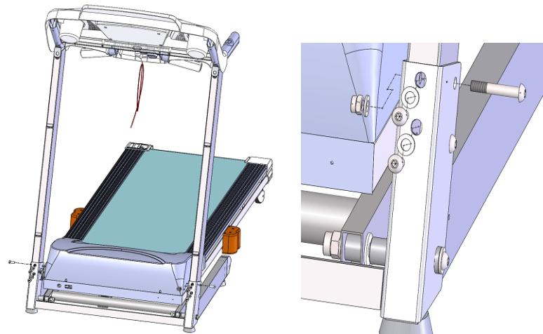
3. Přidržte levou a pravou svislou tyč a pomocí šroubu M8 \* 30 upevněte rám počítače k tyčím.
