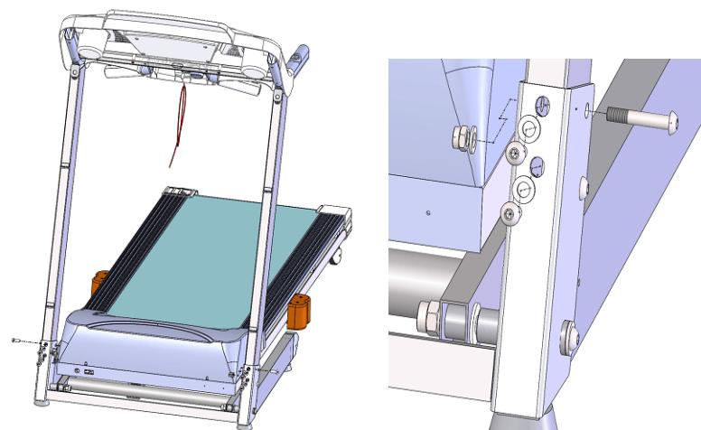
3. Pridržte ľavú a pravú zvislú tyč a pomocou skrutky M8\*30 upevnite rám počítača k tyčiam.
