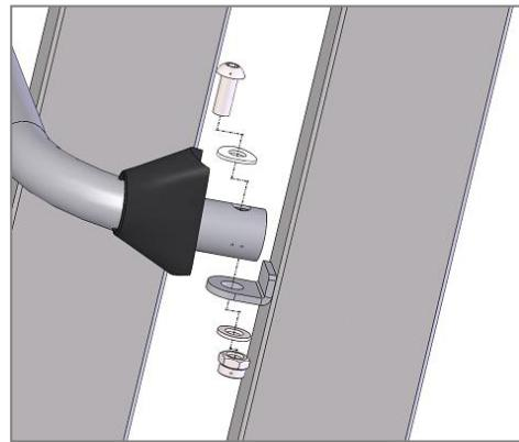
8. Do ramy masażowej przymocować dwie podstawki za pomocą śrub M8\*55.
